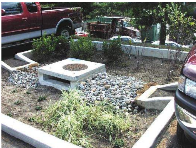
Figura 7.13 – Exemplo de Bioretenção
