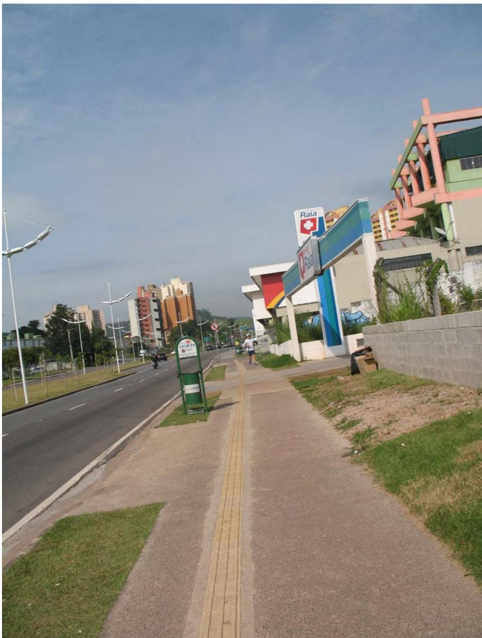
Foto 26 – Passeio com pavimentação adequada ao deficiente visual
