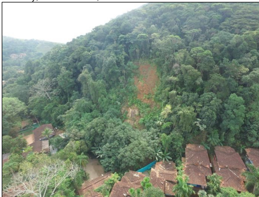
Figura 6 – Escorregamento planar afetando moradias no bairro Cambury, São Sebastião, SP.
