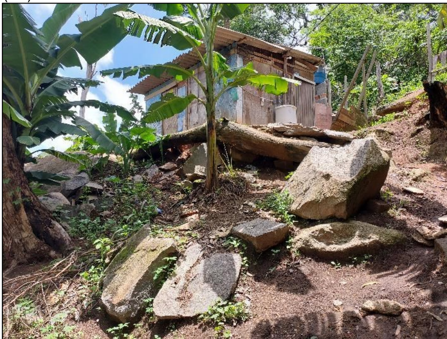
Figura 14 – Situação de risco de rolamento de bloco rochoso, Itapevi (SP).
