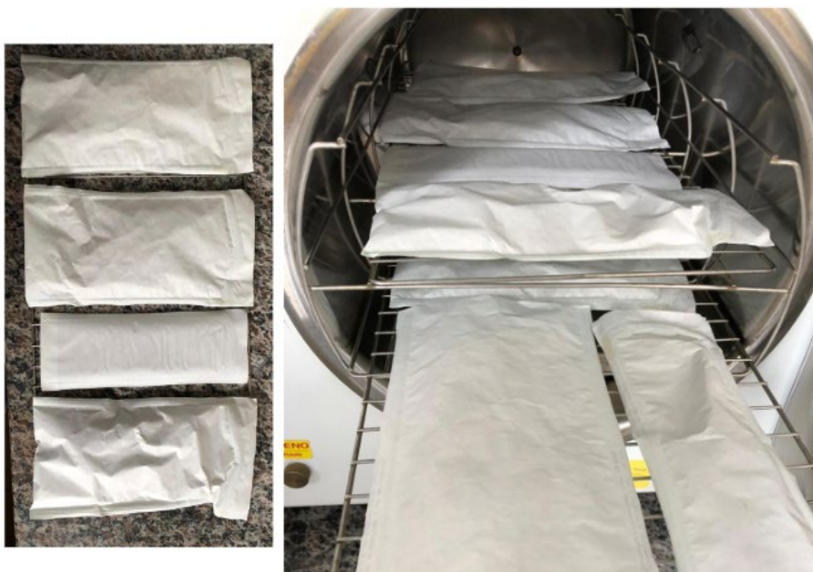
Figura 9: acondicionamento dos pacotes no interior da autoclave
