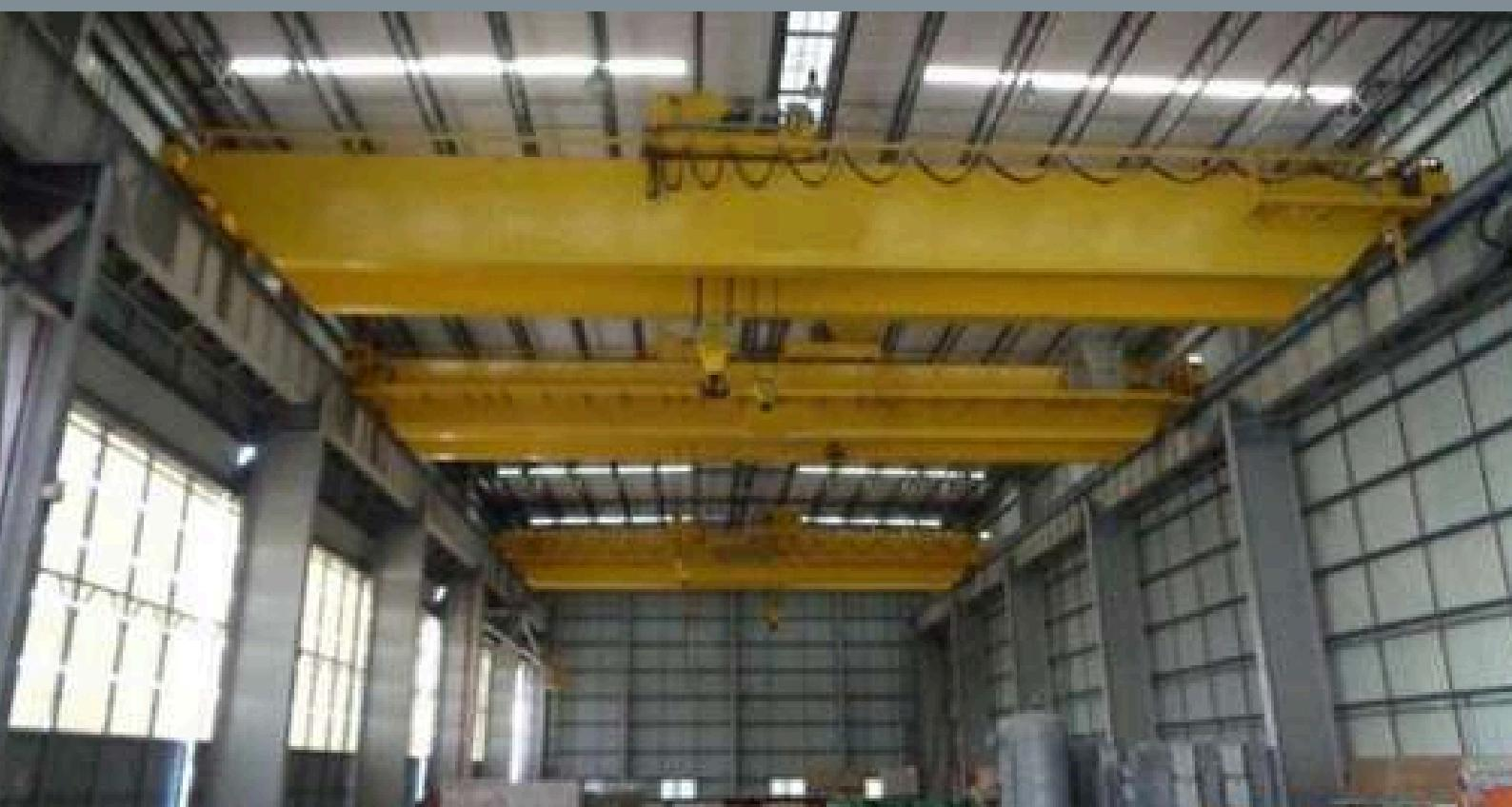
Basicamente, as **pontes rolantes** são estruturas horizontais em pontes que permitem o movimento transversal do guincho, o qual por sua vez trata-se de elementos acessórios acoplados entre si como tambores, cabos de aço, freios, redutores, motores e chassis.
